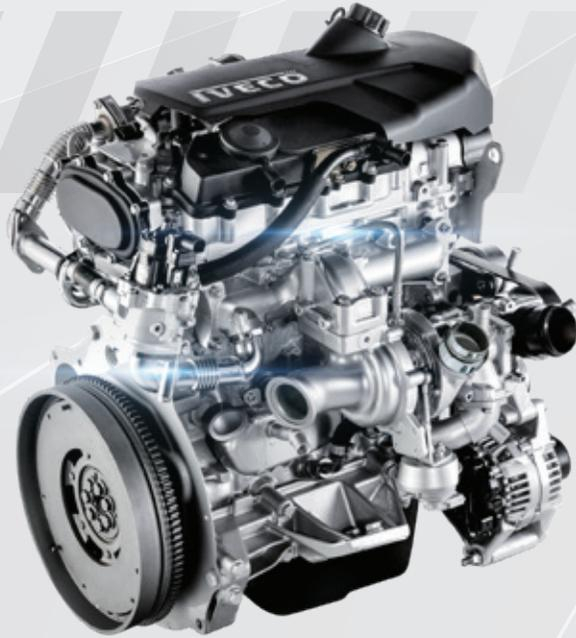
Động cơ sử dụng hệ thống điều khiển áp suất khí nạp bằng điện tử - eVGT (Electronically controlled Variable Geometry Turbocharger) và hệ thống phun nhiên liệu điều khiển điện tử CRDi (Common Rail System), giúp gia tăng công suất động cơ, cung cấp moment xoắn lớn tại dải vòng tua thấp, giúp xe vận hành mạnh mẽ, bền bỉ, tiết kiệm nhiên liệu & thân thiện với môi trường.
