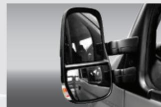
**Kính hậu chỉnh điện** kết hợp với hệ thống sưởi, đảm bảo tầm nhìn tối đa trong điều kiện thời tiết khắc nghiệt.
